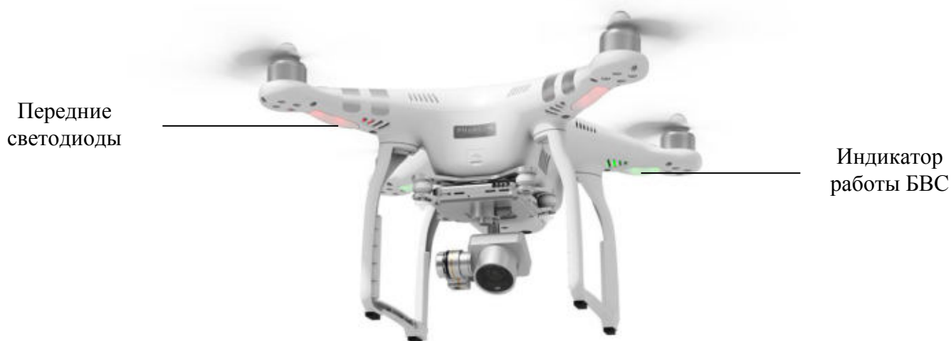
Рис. 8.1. Светодиоды и индикаторы работы БВС
