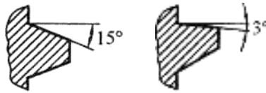
Рис.2.20 Виды сечений витка резьбы.
